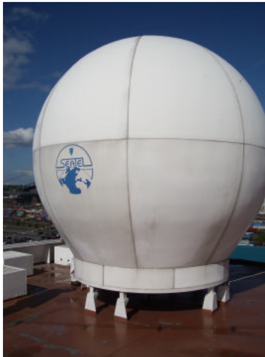
De radome met de schotel erin. Deze radome is ongeveer 4 meter in diameter.
