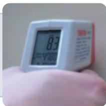
**Genau überprüft: Beschichtung** Mit Hilfe eines professionellen Messgerätes konnte die Dicke der Lack- und Pulverbeschichtungen der einzelnen Antennen überprüft werden. Dabei besaßen Triax und Hirschmann mit jeweils durchschnittlich 91µm die dicksten Beschichtungen. Die Antenne von DCT Delta besitzt mit durchschnittlich 58µm die dünnste, was einer um 36% geringeren Beschichtung entspricht als bei Triax und Hirschmann.
