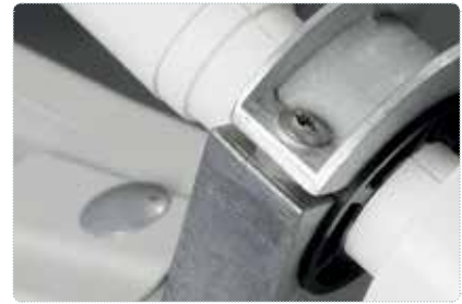
LNB-Halter: An der stabilen, aus Aluminium Druckguss gefertigten und mit zwei Kreuzkopfschrauben aus Edelstahl versehenen Feedhalterung, finden LNBs mit einem Feeddurchmesser von 40mm Anschluss. Über einen Kunststoff-Reduzierring können auch LNBs mit einer 23mm Feedaufnahme montiert werden.
