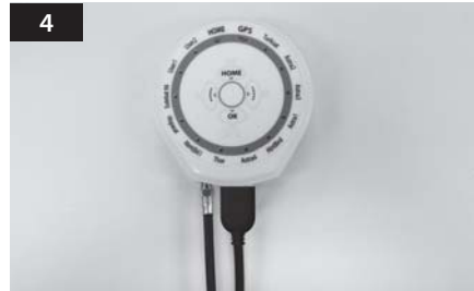
Verbinden Sie das Stromversorgungskabel und das 5C Stromkabel mit dem Steuergerät.
