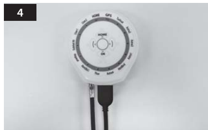
Använd strömförsörjningskabel och 5c strömkabel och anslut till kontrollenheten
