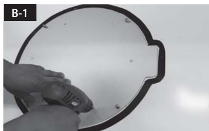
Faire 7 trous (2mm) avec une perceuse électrique
