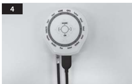
Utilice el cable de entrada de energía y el cable de energía eléctrica 5c para la conectar al Controlador
