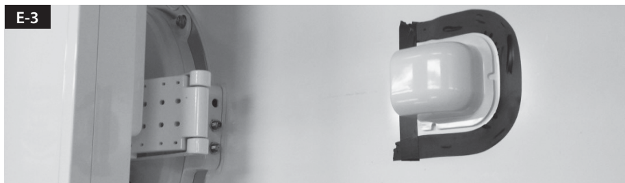
Positionieren Sie den Kabelhalter mittig vor der Antenne (30cm entfernt). Die offene Seite des Kabelhalters soll Richtung Befestigungsplatte zeigen. Danach kleben Sie das Isolierband um den Kabelhalter herum.
