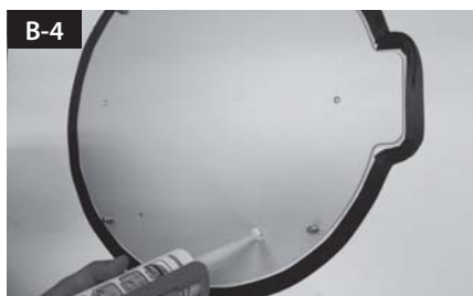
Breng opnieuw siliconenkit aan op de astgedraaide schroeven
