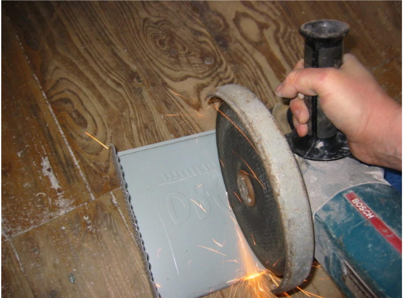
Le disque dur a besoin de respirer, c'est pourquoi, afin de ne pas le rendre claustrophobe, il est préférable de prévoir une ouverture d'au moins la taille du disque dans le couvercle de la dreambox.
