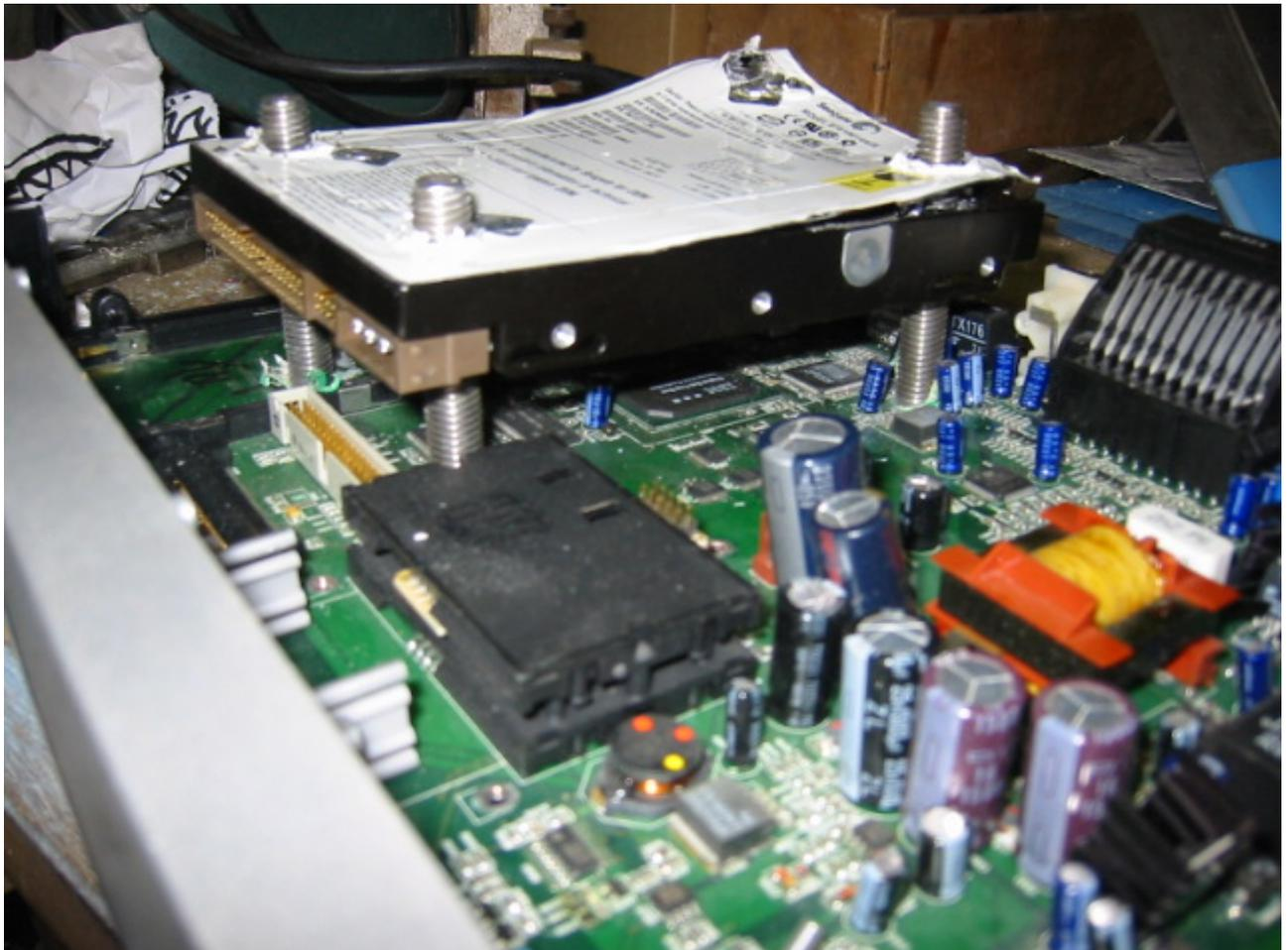
Il est préférable, pour la stabilité du montage, de ne pas laisser dépasser les supports de plus de 28cm en dessous du disque.
