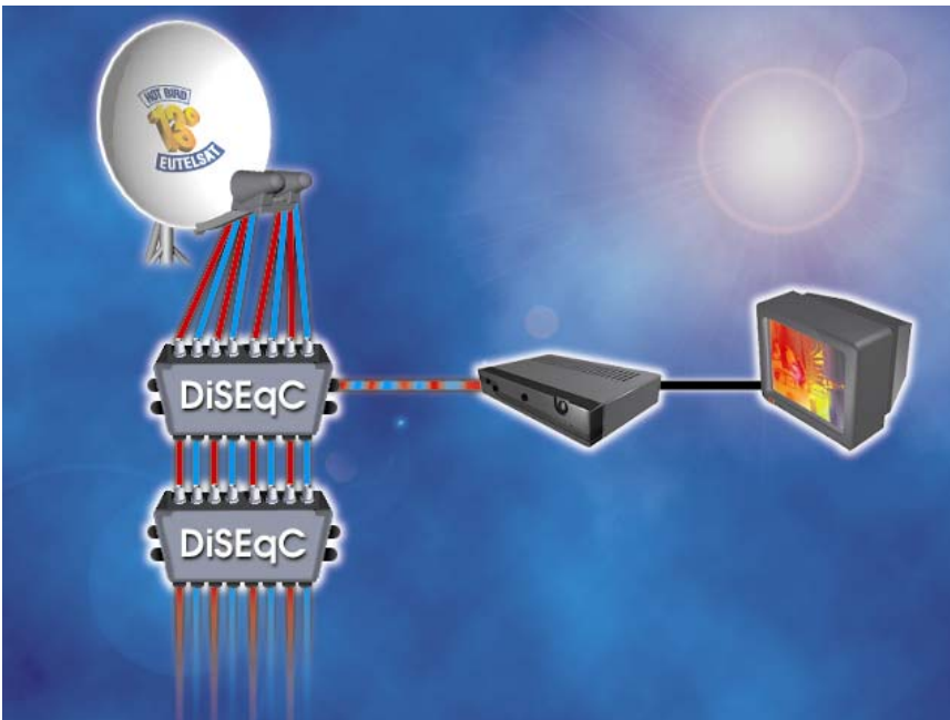
Mehrteilnehmer-Anlagen mit DiSEqC-Technik können auch kaskadiert aufgebaut werden.
