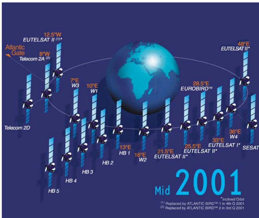
Active Eutelsat-Satelliten befinden sich von 12,5 Grad West bis 48 Grad Ost.
