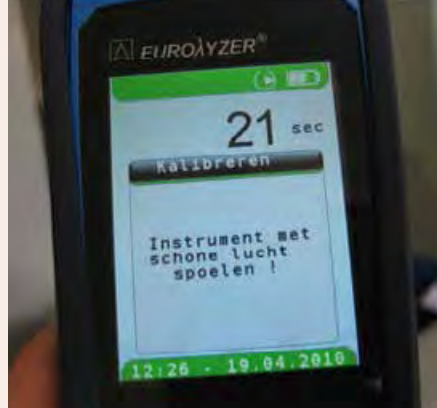
Na het opstarten, de kalibratiefase (30 seconden tot 1 minuut). Automatische controle van de cellen om foutieve metingen te voorkomen
