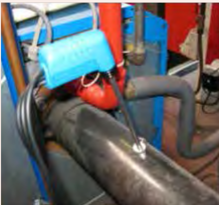
Rookgassonde in het rookgaskanaal steken en in de kernstroom vastzetten
