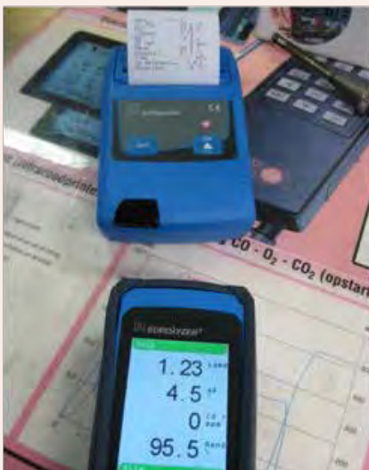
Opslaan of afdrukken van de meetwaarden met de printtoets
