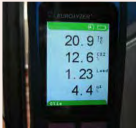
Door een druk op de toets de meting starten, met de pijltoetsen door de verschillende menu's lopen
