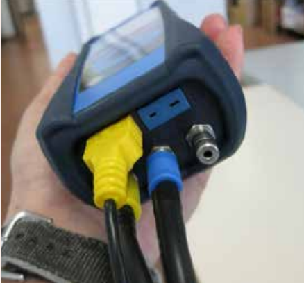
De rookgassonde zorgvuldig aansluiten via een snelkoppeling
