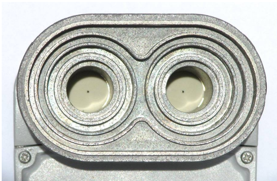
Canal Digitaal duo-Lnb voor een schotel van 60cm
