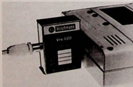
Afb. 63 Meerkanaalsversterker met voorgeschakeld sperfilter voor 4 FM-zenders.
