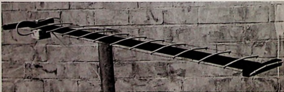
Afb. 57a Draaibaar op een verticaal balkje gemonteerde balkonantenne (beschrijving op pag. 59).
