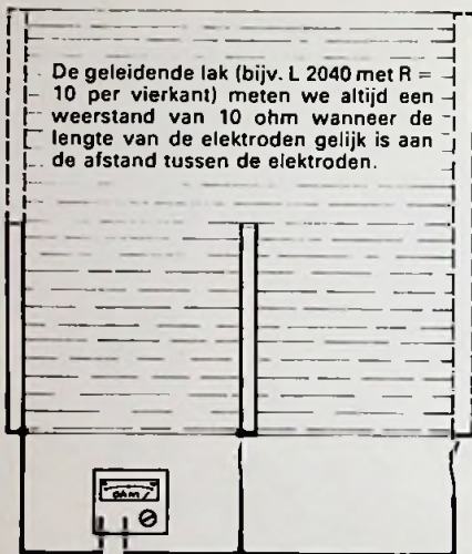
Afb. 38 De elektrische eenheid 'ohm per vierkant'.
